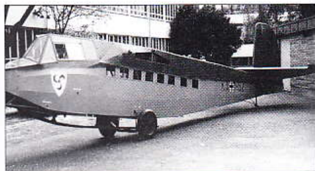
Планер на реставрации. Видны ушки для крепления крыла.
