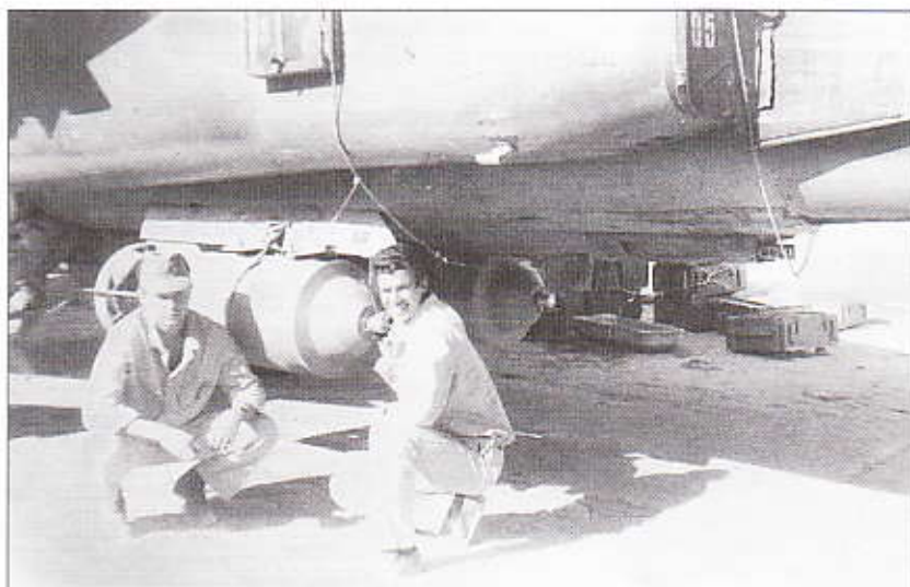
Подвеска авиабомбы ФАБ-500 М-54 на истребителе МиГ-23МЛД. 120-й иап, Баграм, сентябрь 1989 года
